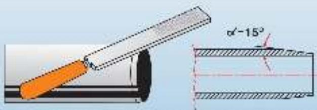
оси. С наружной поверхности торца трубы снять фаску напильником.
