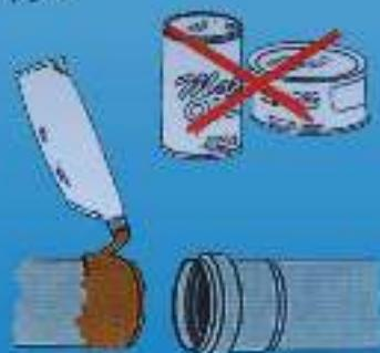
Для уменьшения осевого усилия при монтаже можно использовать специальную силиконовую смазку (нельзя использовать масла или минеральные смазки).
