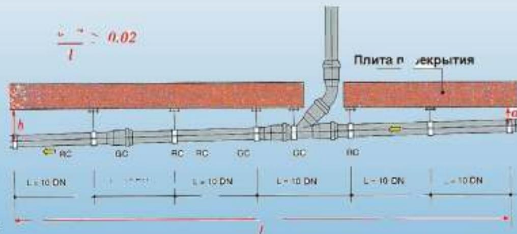
Канализационные трубопроводы ПОПИТЭК жестко крепятся на строительных конструкциях с помощью пластмассовых и металлических хомутов с эластичной прокладкой в соответствии с проектными уклонами, не нарушая целостности соединяемых деталей.
